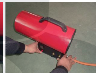
Нажмите и удерживайте кнопку защитного клапана, нажмите кнопку поджига
