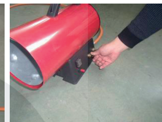
Удерживайте кнопку защитного клапана от 10 до 30 секунд
