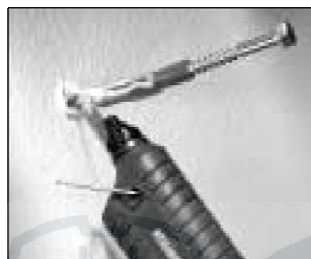
Крепление слабо установленных дюбелей
