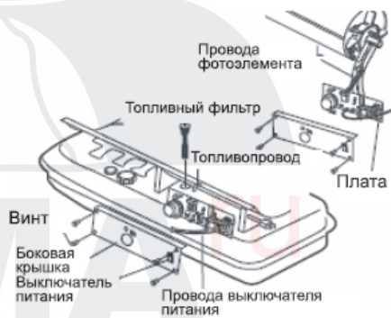
Рис. 21 Установка топливного фильтра
